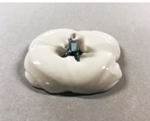
ボードアンカーと硬化剤を複合させて固定します
