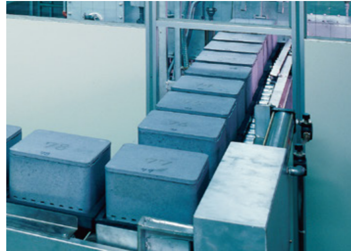
製造ラインを貫通させた間仕切(SL)
