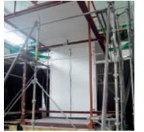
▲ 振動台と試験体
