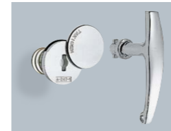
ロック:A-247-1 (タキゲン) ハンドル:No.0061-H (タキゲン) *高遮音スライド点検扉のロックは、開き扉の裏側から解除操作可能で、ロック操作により必要な気密性確保可能なA-247-1での3点ロックとなります。
