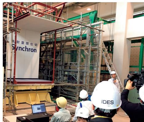
大学との共同研究では、300回を超える加振試験で得られたデータを解析。シンクロンを熊本地震の本震である益城波（震度7相当）で実際に揺らし、試験条件のもとで震度7クラスの揺れにも耐えることを確認しました。
